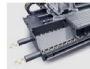
Système à double vis sans fin pour évacuation de copeaux (extracteur à longue queue sur les modèles ZV-ZVH 40 et 50).
