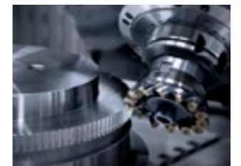
Fonctions pour le taillage avancé d'engrenages (skiving-hobbing), aussi bien pour les engrenages droits qu'hélicoïdaux.
