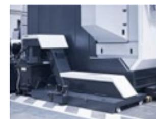
Évacuateur de copeaux avec réservoir de refroidissement intégré.
