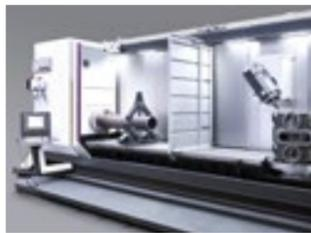
L'option "Non Stop Machining" inclut paroi de séparation centrale, blocage indépendant des portes avant et logiciel de gestion pour les travaux en cycle pendulaire.
