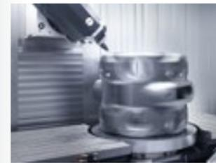
Tables rotatives intégrées d'axe C pour opérations de tournage et de fraisage. Vaste gamme de vitesses de tournage disponibles.
