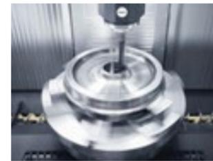
**Zones de travail personnalisées :** Fraisage et tournage d'axe C sur des pièces de grand diamètre par plateaux intégrés sur la table fixe ou remplaçant celle-ci.
