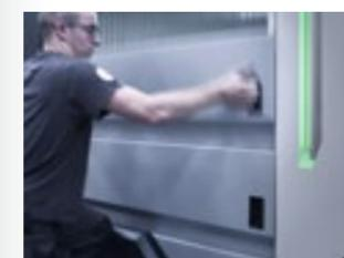
Possibilité de charge de pièces extralarges grâce aux panneaux latéraux facilement démontables.
