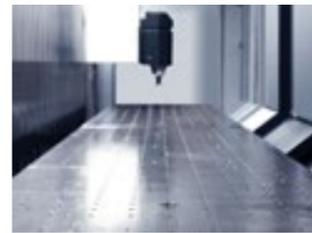
**Système de fixation :** Tables fixes spéciales, avec système de fixation par vide pour des pièces longues en aluminium.
