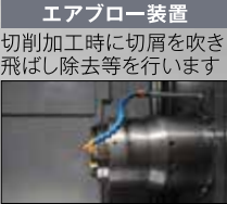
エアブロー装置 切削加工時に切屑を吹き飛ばし除去等を行います
